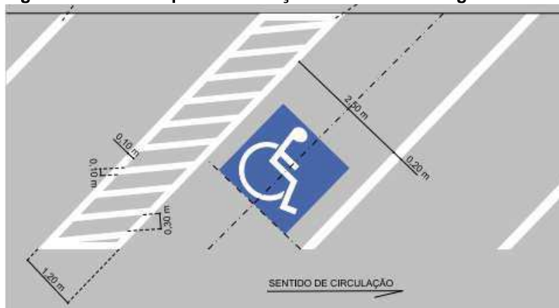
Imagem 9 – Medidas para sinalização horizontal de vagas inclinadas
